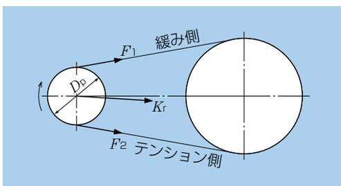
図4.6 チェーン・ベルトに作用する荷重
