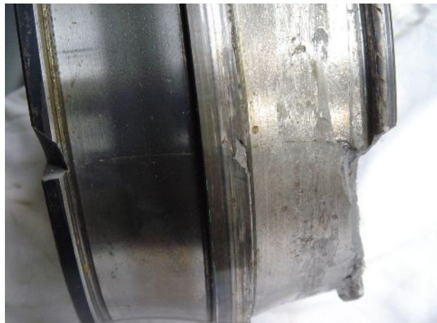
内輪の割れと、内輪軌道面のフレーキング。
