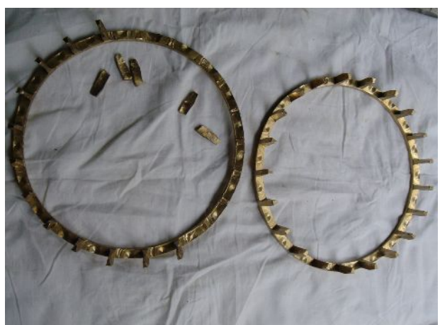
保持器の柱部の変形と折損。(左)
