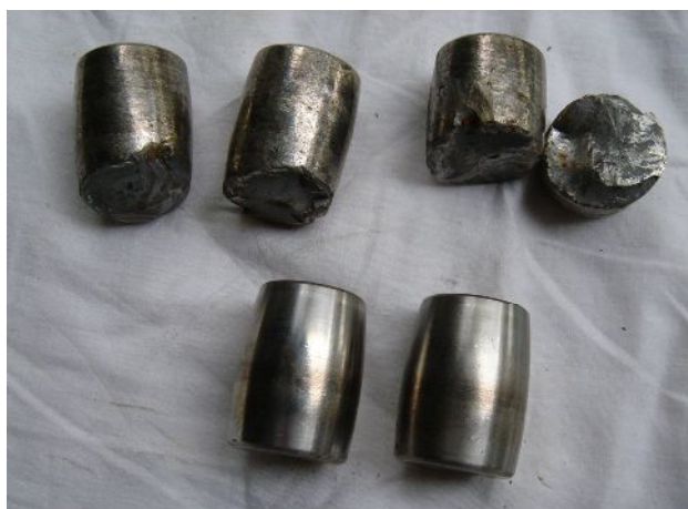
転動体の割れ、かじり。(上) 破片のかみ込みによる圧こん。(下)
