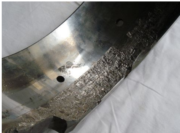
外輪の割れと、外輪軌道面のフレーキング。(深い)
