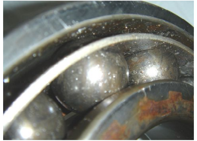
画像2 [駆動側軸受の転動体]
