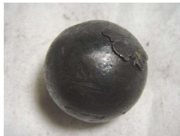
画像5 [反駆動側軸受 転動体]
