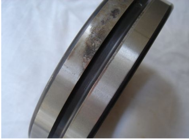
画像1 [操作側軸受 外輪外径面]
