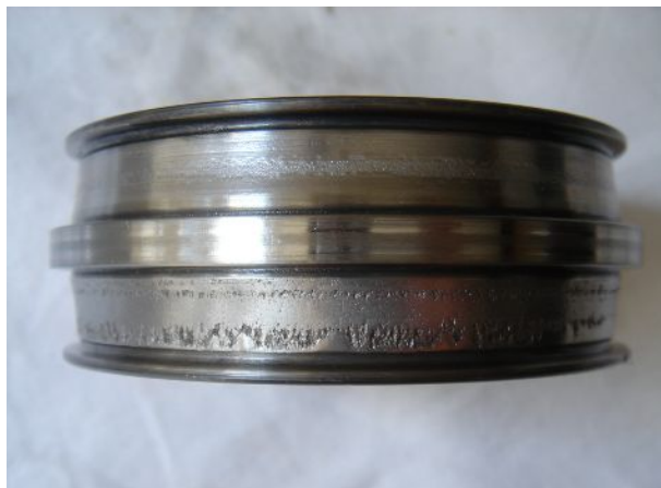
画像5 [駆動側軸受 内輪軌道面]
