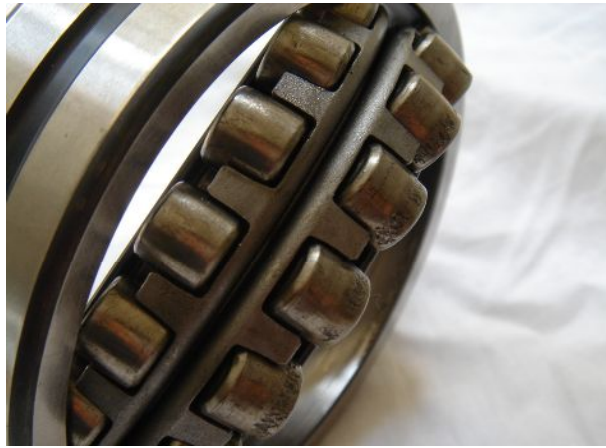
画像3 [操作側軸受 保持器、転動体]
