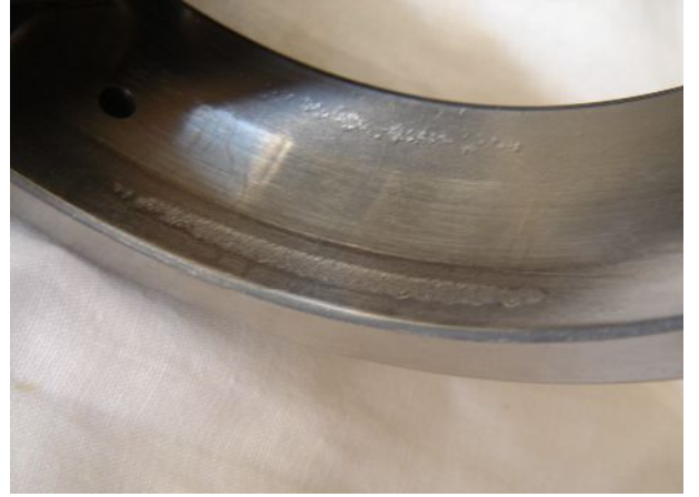
画像4 [駆動側軸受 外輪軌道面]
