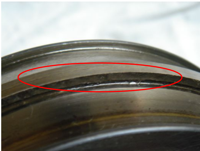
画像 19 [内輪軌道面 内側より]
