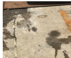
コンクリート上に、エンジンオイル等を200cc流す。表面の油膜がキラキラとしていません。鉍物油専用洗剤を3倍希釈した200ccをエンジンオイルの上に撒き、デッキブラシ等で攪拌し水で流す。表面の油膜がなくなります。撒かれた油はナノ化して水に乳化され、油水分離槽に行きつくまでに空気中・水中・土中の好気性微生物により生分解され炭酸ガスと水に変わって、流した油の量が減っていきます。
