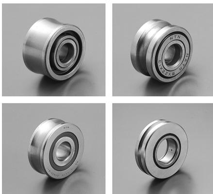
外輪外径に、相手材の形状に合わせた溝を設けた軸受で、ガイドローラとして使用する。溝形状は、R形状やV形状などの加工が可能です。なお、取付けにあたっては、側板をアキシャル方向に固定する必要があります。
