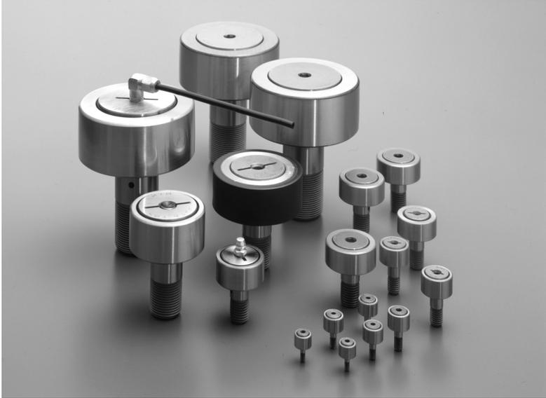
偏心軸の採用により取付け位置の調整が容易で、しかも高精度の取付け穴位置加工が不要になった。更にスタッドに設けたタップ穴は、付属のねじ付きグリースニップルを取り付けて簡単に給脂でき、また集中配管用の取付ねじとしても利用できる。
