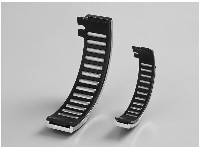
可変容量型プランジャポンプ・モータの変換機構部に従来のトラニオン方式及び滑り接触方式から、斜板背部に、円弧状の転がり軸受を取り付ける方式へ変わりつつある。この方式にすることにより、大きな荷重を負荷でき、よりコンパクト化することができる。
