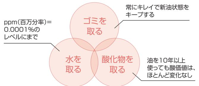
常に新油レベルの清浄度で、適切な粘度と水分値であれば、機械の故障は極限まで減らすことができます。
